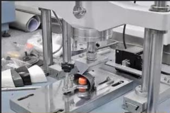
Toecap Test ≥ 200 Joules
